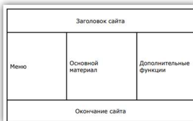
Рис. 2.6. Трехколонная модульная сетка
